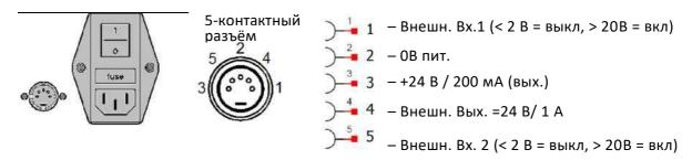
Внешн. Вх.1 = пуск/ стоп; Внешн. Вх. 2 = сброс; Внешн. Вых. = состояние устройства
